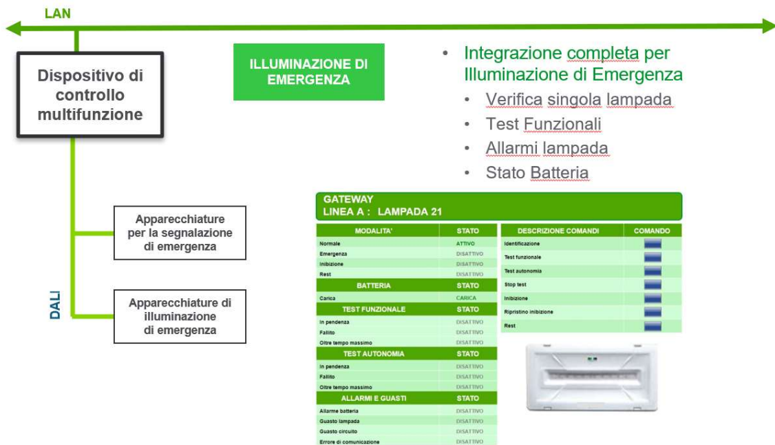
Figura 20: Tipica architettura integrata per l’impianto di illuminazione di emergenza in una scuola “intelligente”
